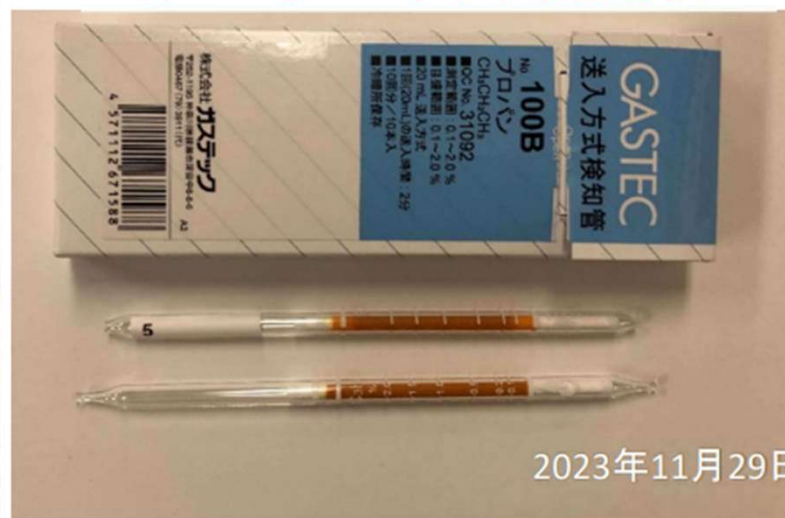
検知管に変色無し (プロパン・ペンタン検出せず)
